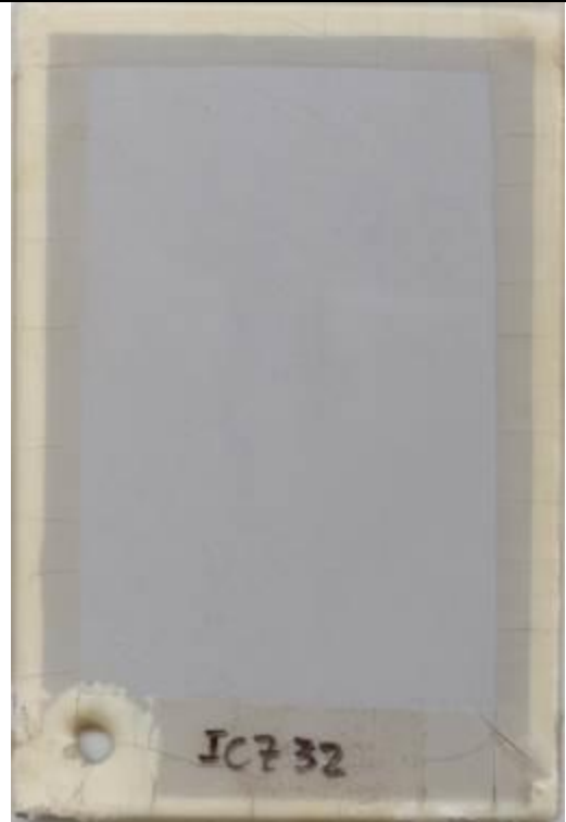
ICZ 32 AZ Armco + system 2 de pintura Marangoni.
