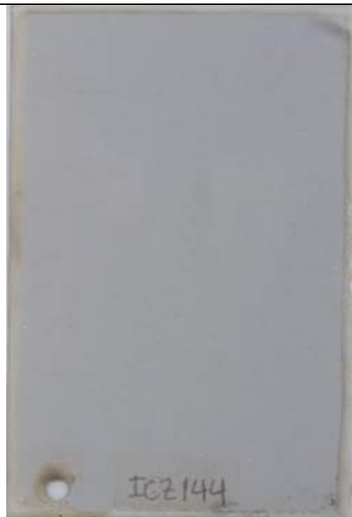
ICZ144 AZ lavado + pré-tratamento híbrido _ sistema 1 de pintura da SW
