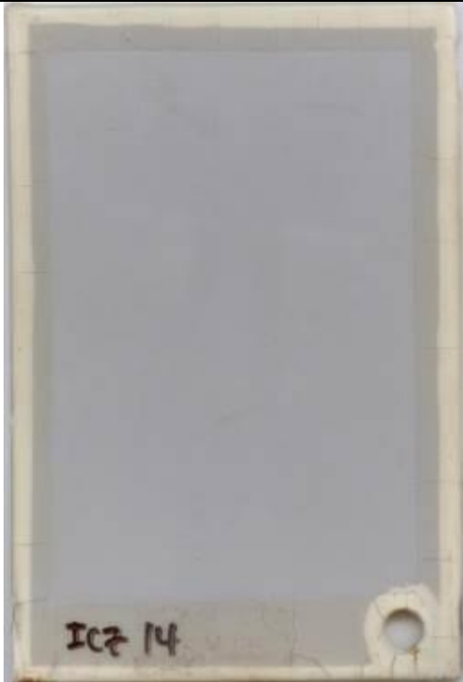
ICZ 14 AC jateado SA 2 ½ com sistema 2 de pintura Marangoni.
