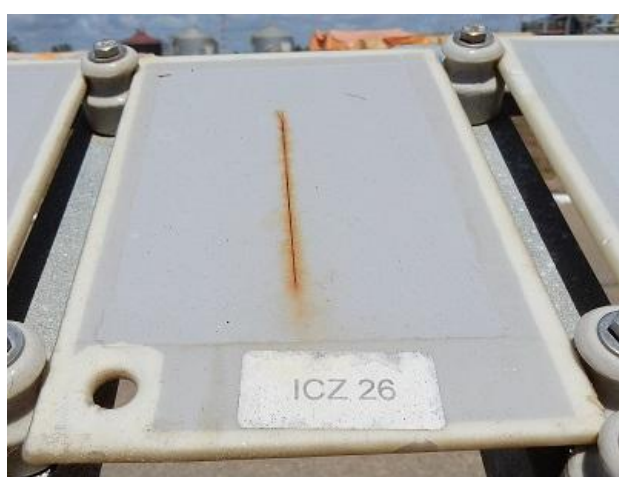
Figura 12 – Aço-carbono pintado (tinta base aquosa – corpo de prova ICZ26);
