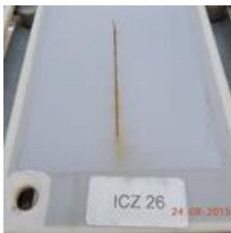
Figura 12 – Aço-carbono pintado (tinta base aquosa – corpo de prova ICZ26);
