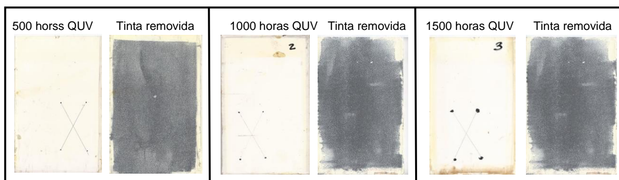
Figura 5 – Aspecto dos painéis depois de 500, 1000 e 1500 horas expostas no teste cíclico de radiação UV (revestida – à esquerda e revestimento removido - direita)
