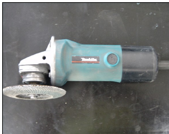
Figura 3 – Esmerilhadeira e disco de lixa utilizados no lixamento mecânico manual.
