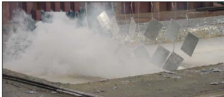
Figura 2 – Peças já zincadas saindo do banho de zinco e operador lançando cloreto de amônio sobre o banho e sobre as peças.
